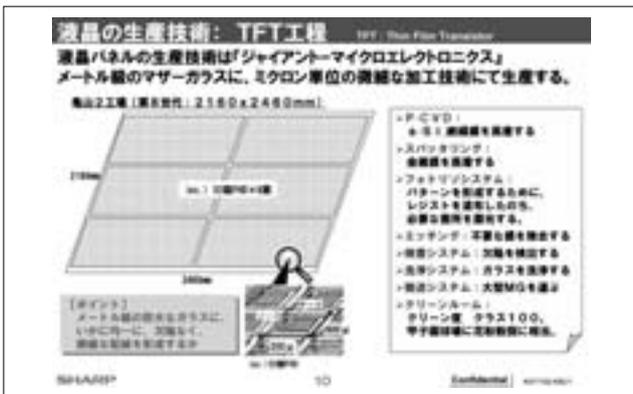
例えば、我々は亀山の第2工場第8世代のパネルを作っていますが、サイズは2160mm×2460mmという非常に大きなマザーガラスで、52型の液晶パネルであれば6面取れるサイズです。我々の製造ラインではこの大判を生産していますが、この一つのパネルの中に薄膜のトランジスタの微細な配線を形成しています。この作り方というのは実はLSIと同じです。LSIというのは密度を上げる為にはパターンを縮小しています。液晶の場合はそれ程精細度を上げてはいないのですが、ガラスサイズをどんどん大きくしていきます。ジャイアントマイクロエレクトロニクスと言われているのですが、どれだけ大きなマザーガラスに微細なパターンを形成するかというのが技術力になります。この薄膜のトランジスタを形成するというのが私の20年
