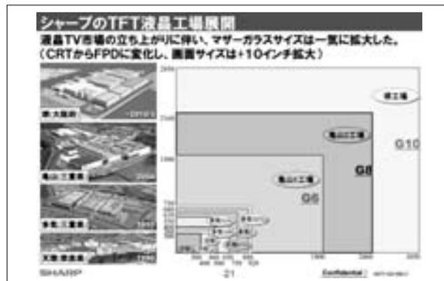
我々の工場の変遷ですが、今の亀山の工場の前にも2つの工場がございまして、さらに2010年に堺に新しい工場を展開しようとしています。1986年にスタートした時は30cm角のガラスでしたが、亀山で一気に1500mm×1800mmという32型が8枚とれるガラスを展開し、さらに46型が8枚とれる第8世代と言われるガラスを生産しているわけです。堺の工場ではもっと大きくして、2850mm×3050mmという57型が8枚とれるガラスで量産性を高め、さらにこれからの大型化に展開して行こうと進めております。
