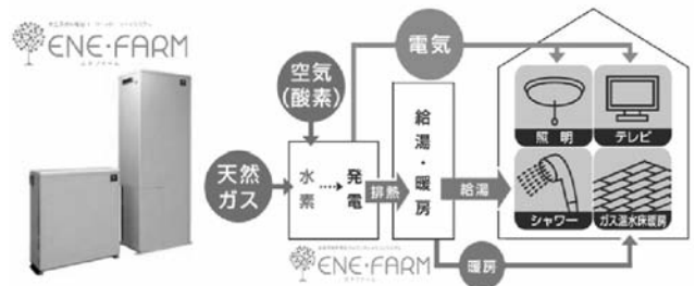
図2 燃料電池による発電および暖房・給湯
