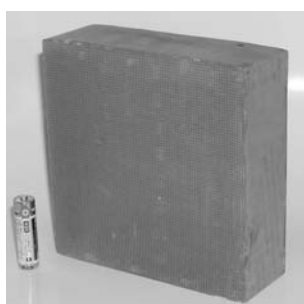
図6 ガスエンジン用高耐久性三元触媒
