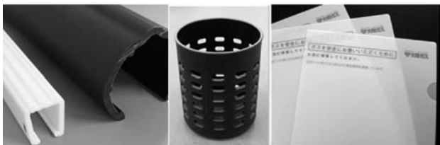
図10 用途例（左から、Tダイシート成形、射出成形（ペン立て）、インフレーションフィルム）
