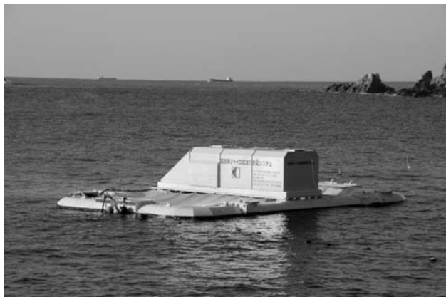
海上実験中の45kWジャイロ式波力発電システム
