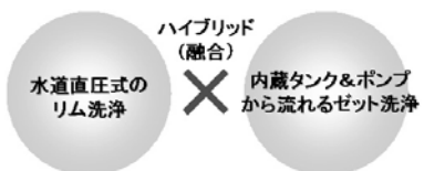
図25 ハイブリッド洗浄システム
