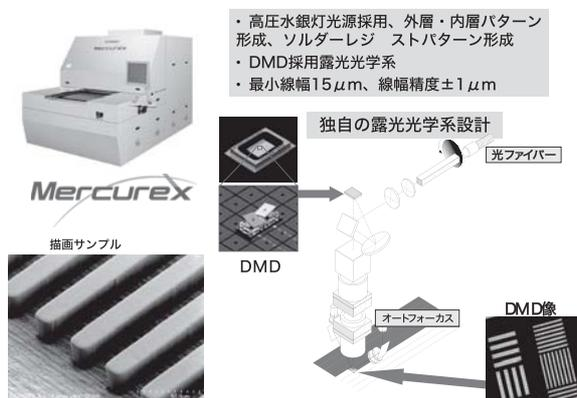
図17 プリント基板直描装置の技術
