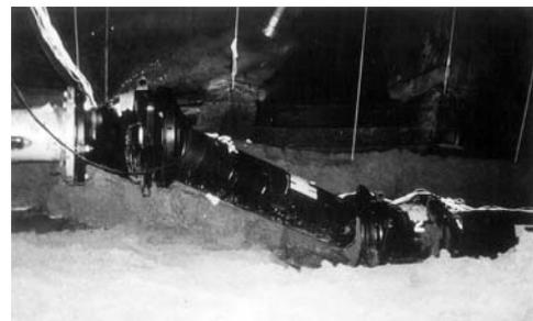
写真-2 液状化した地盤に追従した伸縮可とう管(実験後)
