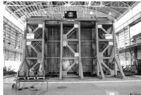
写真-1 大型振動台施設での耐震検証実験
