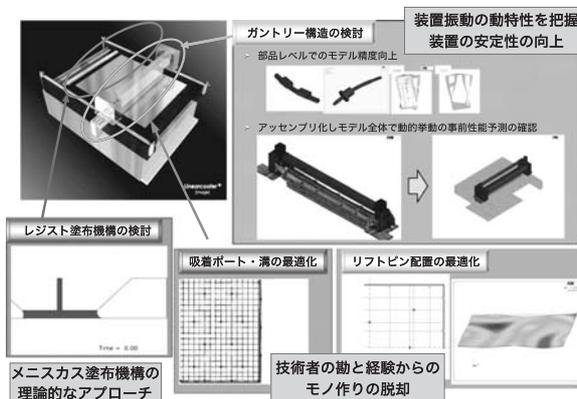
図15 リニアコーター装置開発のシミュレーション設計
