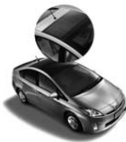
図9 プリウスに搭載された太陽電池モジュール
