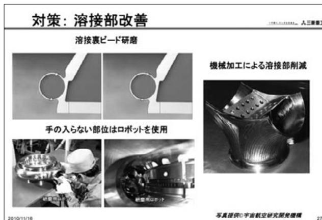
図の左上のように、溶接には裏ビードというのがあります。こういう所は応力集中してしまいますから、非常に硬い金属ですが苦勞して全部削りました。手の入らない細い部分はロボットで削るということもやりました。あと溶接で接合していたところを機械加工で一体で作るような変更もしました。
