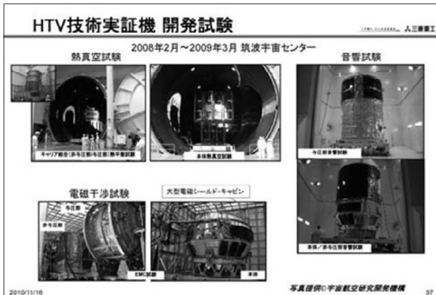
こういう大きな宇宙機の開発試験ですが、熱真空試験、音響試験、電磁干渉試験などを13か月掛けてやりました。その後、種子島へ持って行くために、バラバラにして船に乗せて射場へ持って行きましたが、また現地で組み立てるのに約5か月掛かりました。その後ロケットに渡してから、1.5か月掛けて打ち上げまでいきますが、種子島では半年掛かりの仕事です。
