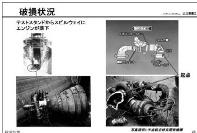
燃焼試験は左上の図の一番上の部分でやっていたのですが、エンジンを燃やすと凄い高温の燃焼ガスが出るので、下部に水を噴射して冷やします。爆発でエンジンを支えている部分が燃えてしまって、下まで落下してしまいました。その頃LE-7の開発は注目を受けていましたから、ヘリコプターが鹿児島から飛んできて撮影され、当時の新聞に載りました。右側の図の矢印の部分(起点)に亀裂が入り、燃焼ガスが噴き出たのですが、タービンの背圧側になるので、ここが破れるとターボポンプが過回転し、非常に悲劇的な事故になります。
