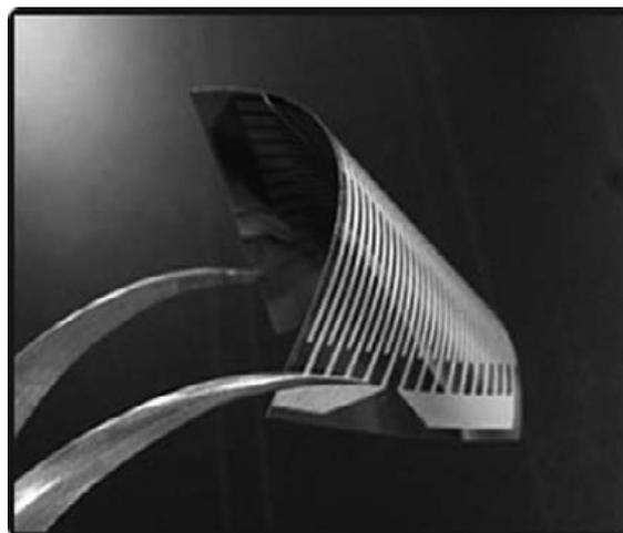
写真21 「高導電銀ナノ粒子ペースト」をスクリーン印刷・熱処理
