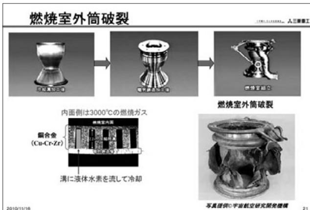
この図は燃焼室です。断面図で井桁状になっている部分は銅合金で出来ています。銅合金を円筒形にして溝を掘り、外側を銅メッキで蓋をしています。その溝の中を液体水素が通り冷却します。内面側は3000℃で燃えています。それだけでは弱い
