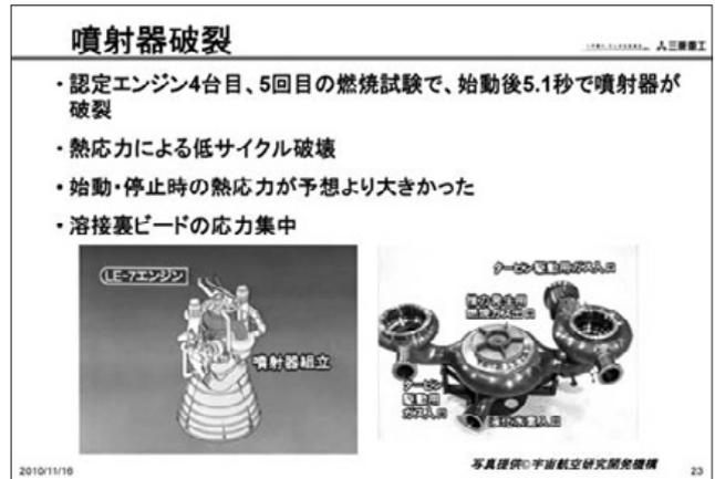
一番苦勞したのは噴射器（燃焼室で燃やすために燃料を噴射する部分）です。大きなものですが軽くしないといけないので、溶接で継ぎはぎして作っていました。結局その溶接がまずくて、これが破裂した事故が2回ありました。最後の事故は打ち上げ2年前に起きたのですが、認定エンジンと言いまして、それが合格すれば、もう打ち上げだという段階でした。その4台目で350秒の燃焼を2回成功し、「いけるかな」と思って、5回目の試験をやったら、始動後5.1秒で破裂しました。原因は比較的簡単で、熱応力による低サイクル疲労破壊を起こしたものです。立ち上げる時の温度差で亀裂が入ったもので、思っていたより熱応力が大きかったことと、溶接の品質があまり良くありません
