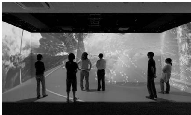
写真2： \pi -CAVEの全景（正面、右左側面、床面の4面）
