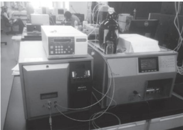
ポリマーの分子量サイズ測定に用いるゲル浸透クロマトグラフィー装置 (GPC)
