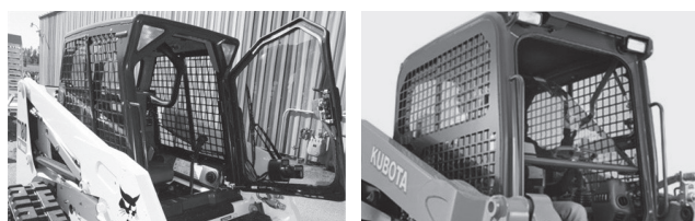
(a) 前方横開き式 (他社) (b) 上部跳ね上げ式 (クボタ)
