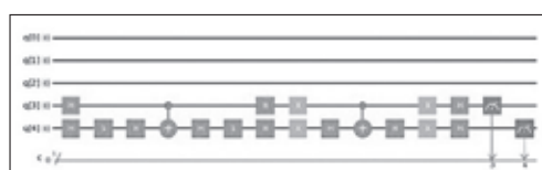
図9 グローバー探索の回路の例（解が“01”の場合）
