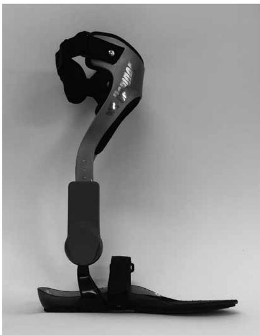
図9 MR-AFO パッシブ型アシストロボット
