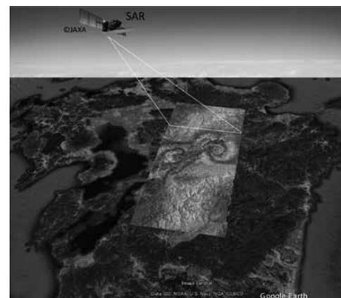
図2 SARによる変位計測のイメージ(地形写真はGoogle Earth, SARデータはJAXA提供、解析結果(位相差画像)は講演者ら)
