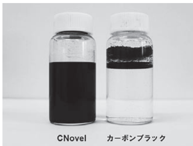
図9 CNovelとカーボンブラックの水への分散写真
