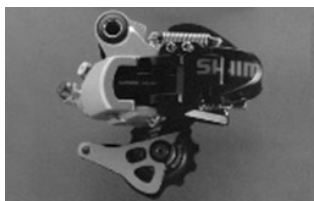
ダウンヒルでの使用を前提に7速専用となったリアディレイラー
