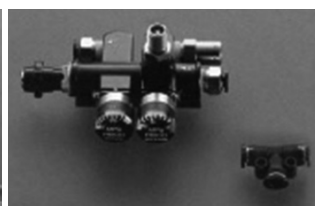
エアタンクから二次側へ供給する空気の圧力が一定に保たれるように制御するレギュレーター
