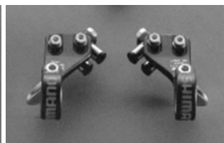
リア変速のための、ダウン・アップシフトをわかりやすく左右に分けたシフター
