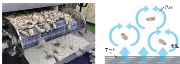
図10 フローフリーズフリーザーの原理
