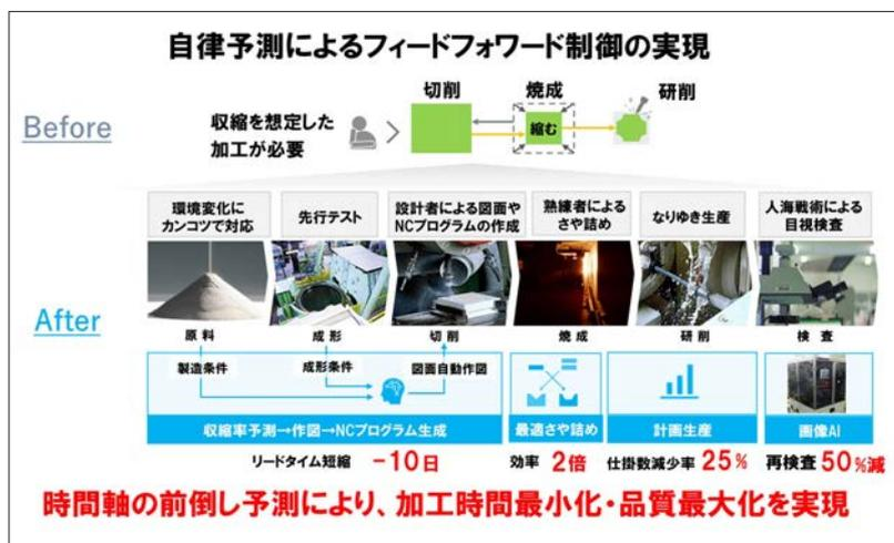
図5 自律予測によるフィードフォワード制御の実現
