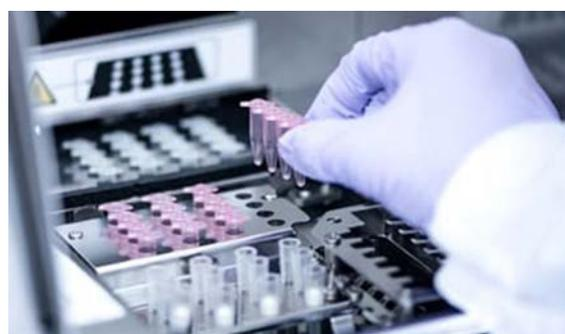
図10 反応容器 (奥)、試薬容器、分注チップ (手前) をAutoAmpにセットしている様子
