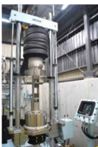
高圧水素ガス環境中の材料強度評価装置 圧力：140 MPa、温度：-80～90℃、最大荷重：100 kN 引張試験(SSRT)、疲労試験、き裂伝播試験、破壊じん性試験
