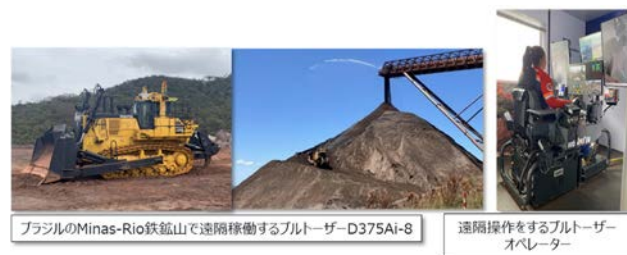
図-8 鉱山現場での遠隔操作ブルドーザー
