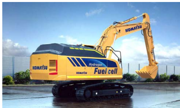
図-10 水素燃料電池搭載型中型油圧ショベル（コンセプトマシン）
