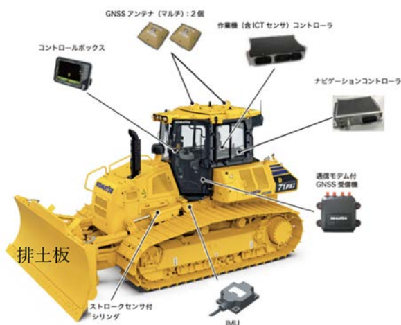
図-3 ICTブルドーザーの概観と機器構成
