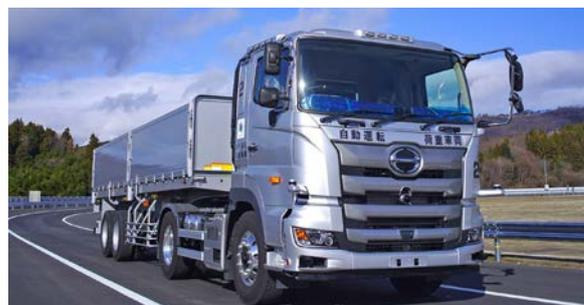
図12. 舗装評価路で無人走行試験中の自動運転荷重車両
