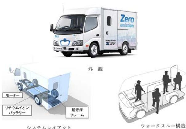
図5. 小型電動トラック「Dutro Z EV」
