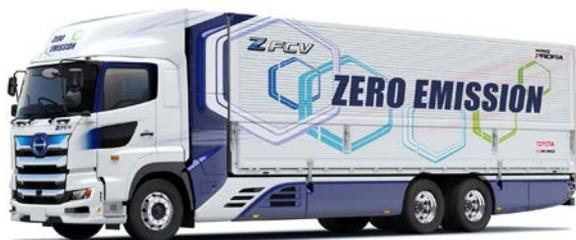
図6. 大型トラック用FCEV「プロフィア Z FCV」
